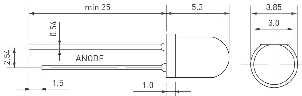
Все размеры указаны в миллиметрах. Допуск  $\pm 0.25$  мм, если не указано иное. Максимальный размер выступающего уплотнения ножки под фланцем составляет 1.5 мм.
